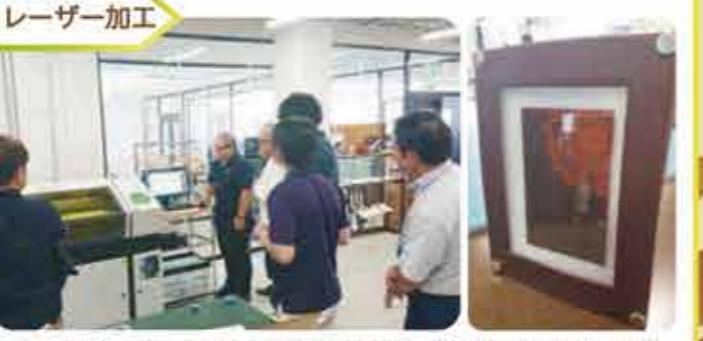
レーザーを照射することで断面をキレイにカットしたり、2層構造のレザーやアクリル板の表面を焼き削ることで質感を活かした極細のデザインを施すことができます。
