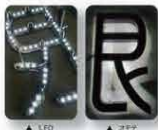
▲ LED ▲ オモテ LEDのセットが終わると、施工前に工場にて不点がないか、均等に照らされるかをチェックします。 ※バックライトタイプです
