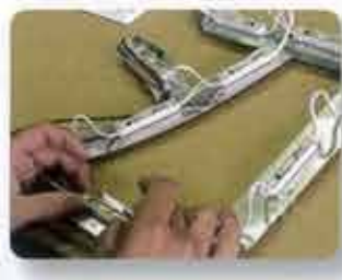
LEDはただ取付けるのではなく、点灯時に均等に光で照らされるよう細かく確認しながらの熟練の技が必要です。
